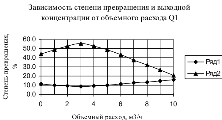
Рис.2. Зависимость степени превращения (1) и концентрации вещества А на выходе (2) из схемы от объемного расхода Q_1
