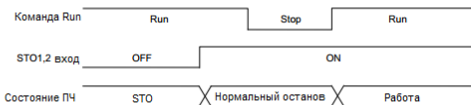
Рисунок 4 - Диаграмма работы функции STO до и после пуска ПЧ
